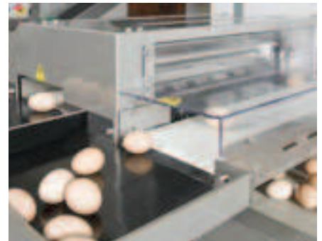
Abhängig von ihrem Gewicht werden die Eier auf die 3 Ausgänge des Ovograder verteilt.
