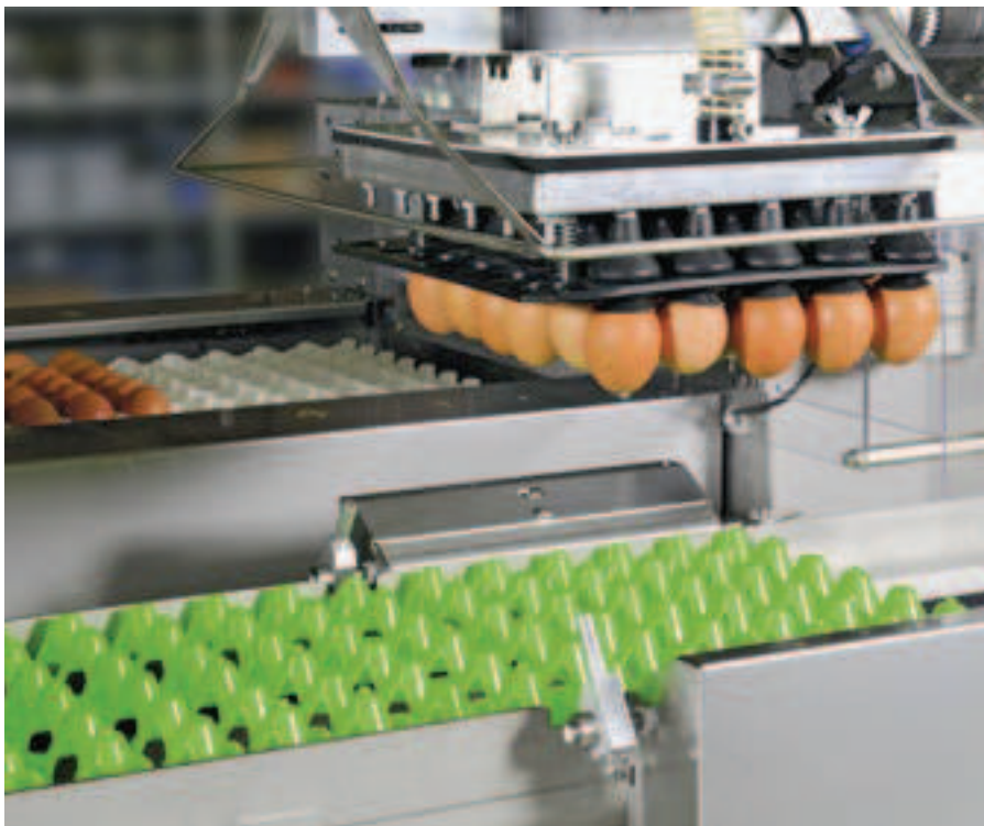
Transport der Eier mit dem Ovoset Pro von Prinzen, der ebenfalls B&R-Technik beinhaltet.
